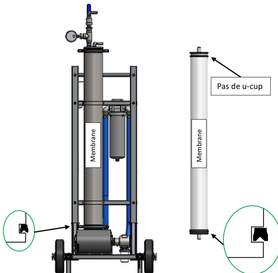
Pour retirer les membranes du concentrateur, vidanger d'abord tout liquide pouvant être resté dans les caissons en utilisant les valves de drainage. Par la suite, dévisser le collet et retirer le couvercle du haut. Pencher le concentrateur vers le bas et sortir les membranes. **Attention : ne pas sortir la membrane avec une paire de pinces par le tube de filtrat! Le tube pourrait être endommagé et la membrane pourrait alors laisser passer du sucre par le filtrat.**
