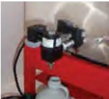
Valve d'embouteillage électrique
