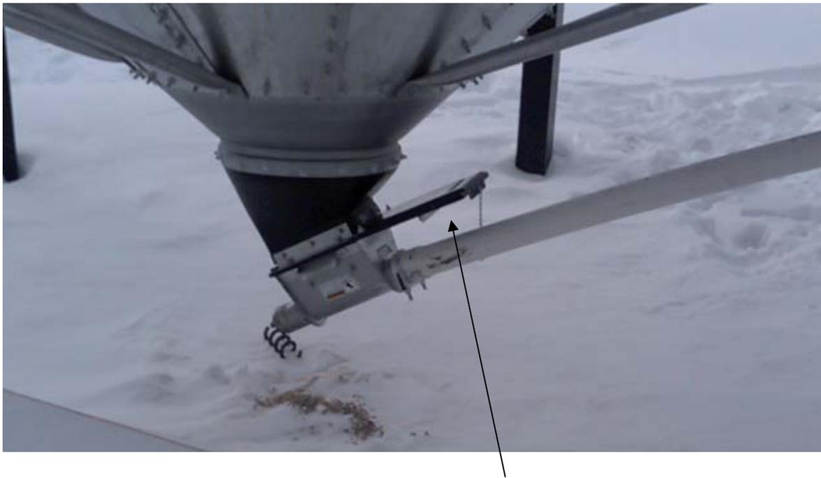
Valve à guillotine sous le silo, ouvrir à 1/3 en opération normale
